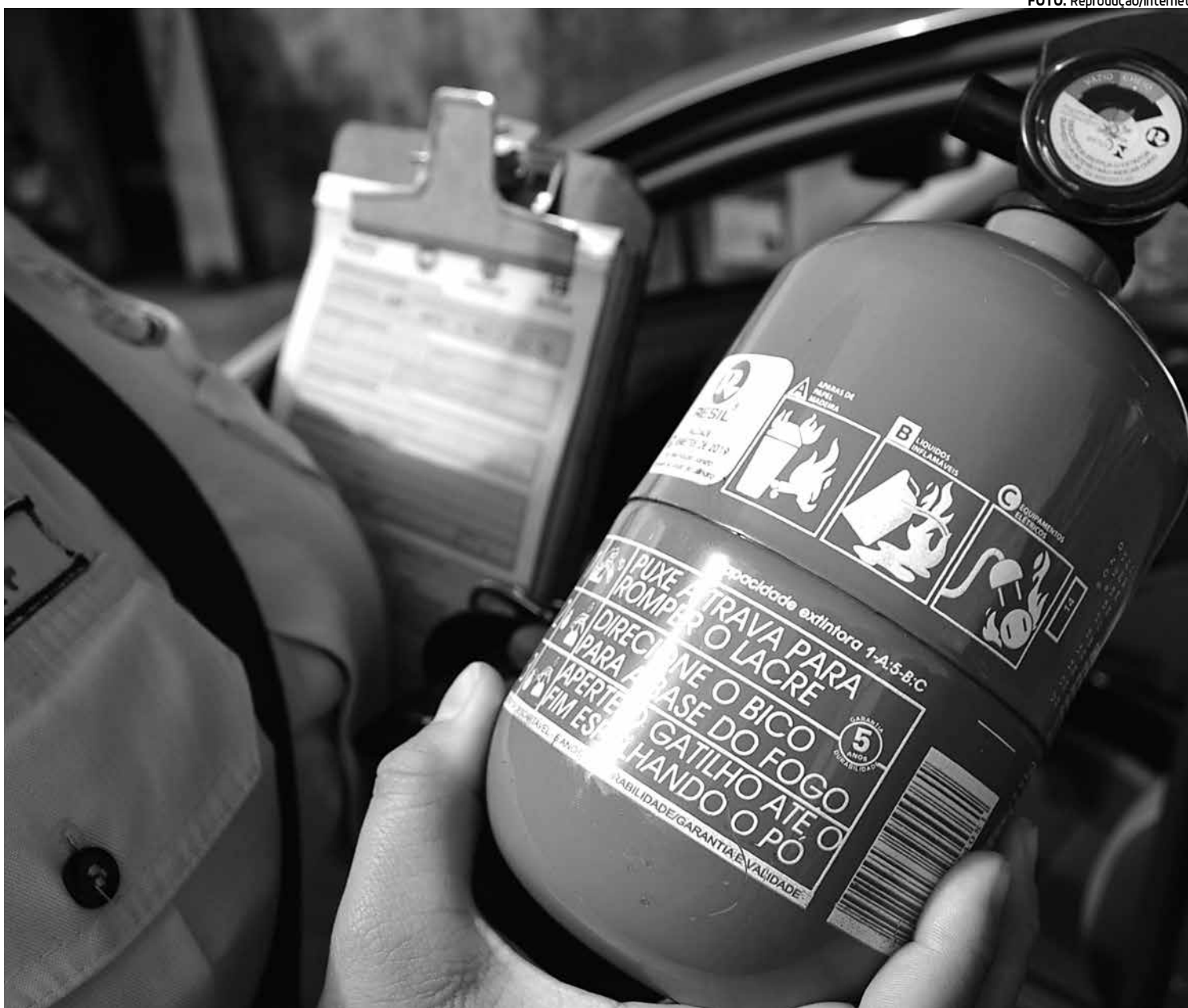
Extintor ABC apaga incêndios em materis sólidos, a exemplo de pneus, estofamentos, tapetes e nos revestimentos
